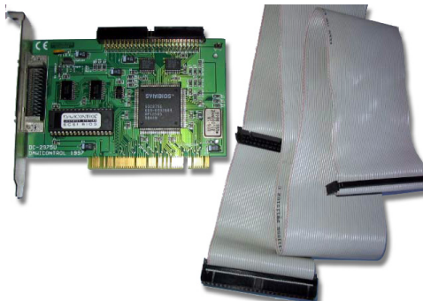
SCSI řadič a kabel (paralelní), zdroj
