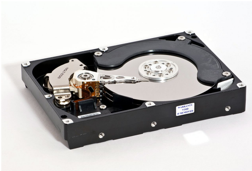
Pevný disk (HDD, 3,5"), bez krytu, zdroj
